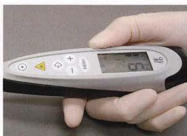
図14 キャリブレーションが成功すると、セラミックリファレンス番号がMOMENT PEAKに表示される
