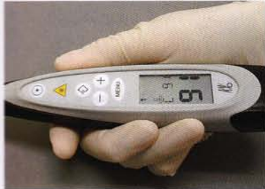
図11 キャリブレーションが成功すると、セラミックリファレンス番号がMOMENT PEAKに表示される。
